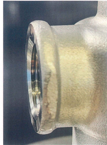
(図 2) 0.02MPa 出口側 (石鹼水の膨らみなし)
